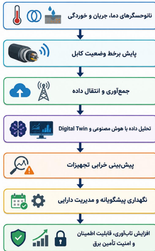
شکل ۱. نقش نانوحسگرها در افزایش تاب‌آوری شبکه برق
